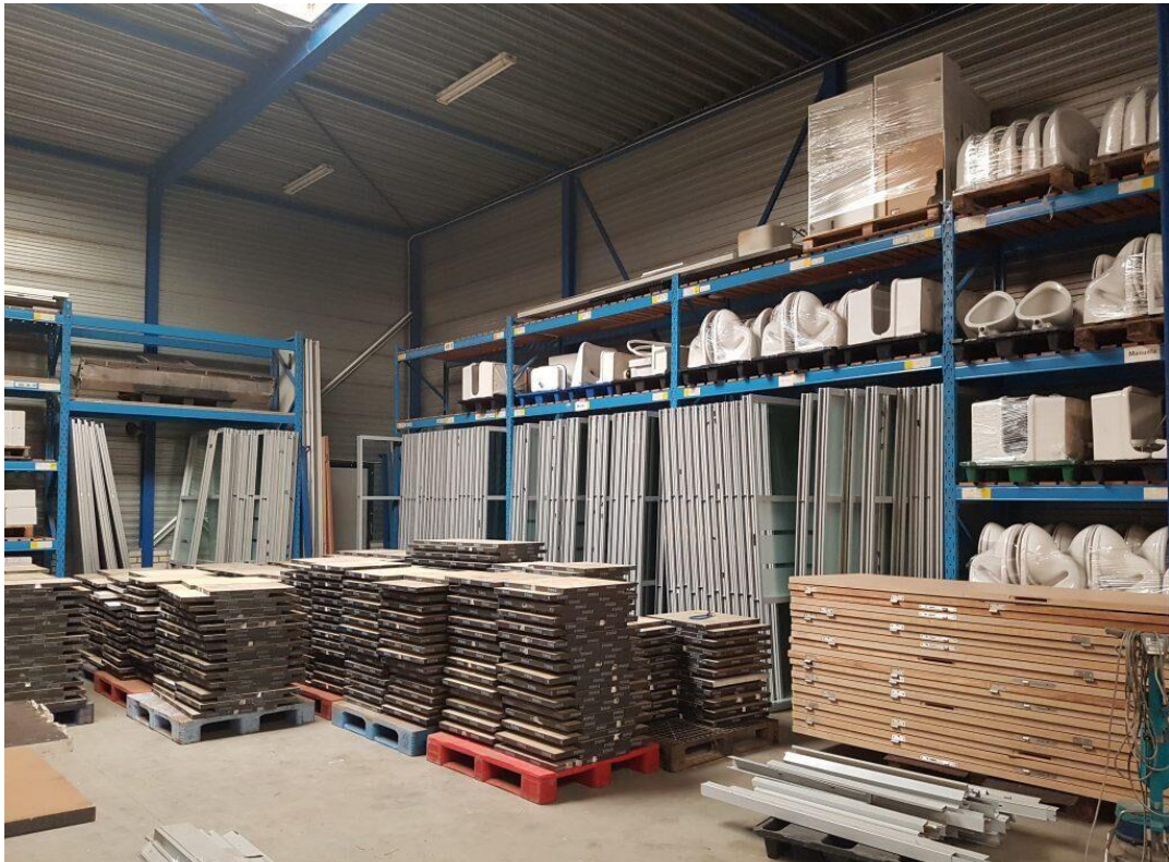
Figuur 6: Voorbeeld van een bouwhub: een opslag van gebruikte materialen, klaar voor hergebruik (Foto: Beelen Next)
