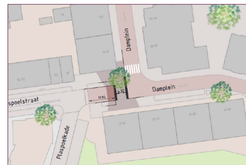
Figuur 3.5. Variant Damplein met inritconstructie en VOP
